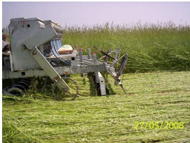
Einsatz der Eco-Dyn am Betrieb Brunner Umbruch und Direktsaat in einem Arbeitsgang
